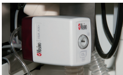
呼吸ガスセンサ※ サイドストリーム方式。CO 2 のみ又は麻酔ガスも測定できる2タイプがあります。
