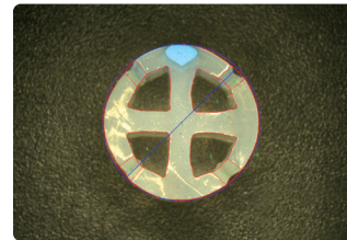
■溝型ラウンド型ドレーンの断面
