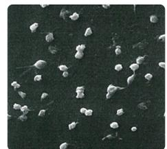
牛血循環に6時間曝した材料表面をリンスし、ヒト血漿を滴下して4時間経過後の血小板粘着の様子(SEM画像)
