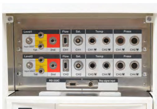
■センサBOX HAS III-SB1/-SB2 外部出力機能搭載
