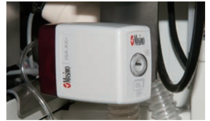
呼吸ガスセンサ ※ サイドストリーム方式。CO 2 のみ又は麻酔ガスも測定できる2タイプがあります。
